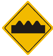
Señal: Calzada ondulada. (P-32)
