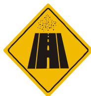
Señal: Fin de pavimento. (P-31)
